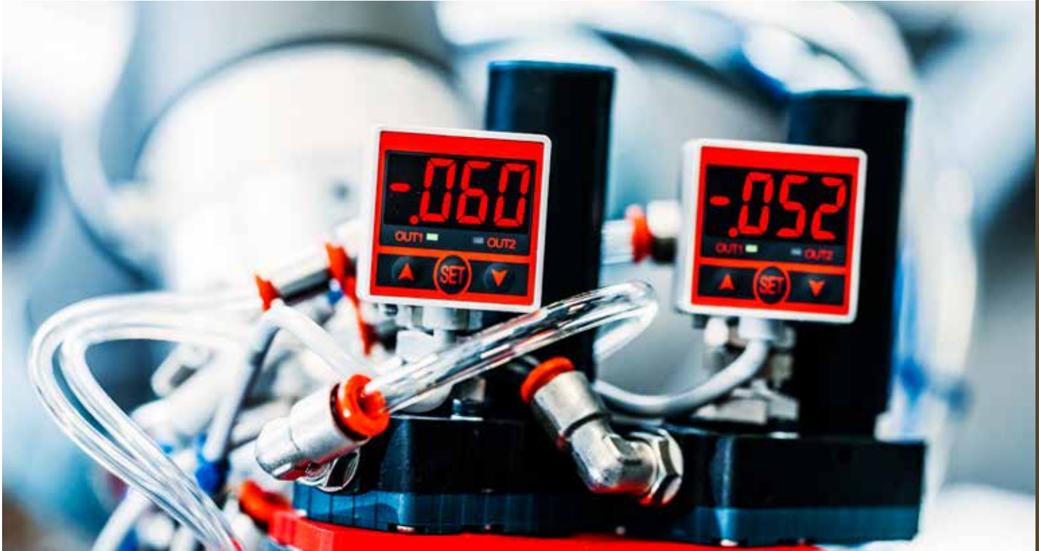
På billedet ses en vakuumstat, der sidder på en griber. Griberen sidder på en robot, og den kan ved hjælp af vakuum tage fat i forskellige emner. Foto: Teknologisk Institut
