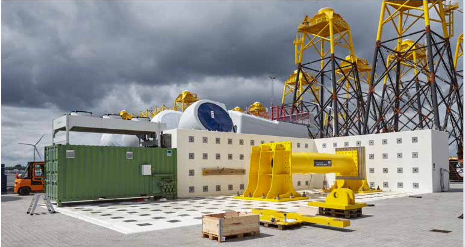
FORCE Technologys mekaniske testbænk er specialdesignet til afprøvning af meget store komponenter og strukturdele for eksempel med henblik på at dokumentere overholdelse af standarder og designspecifikationer. Foto: FORCE Technology
