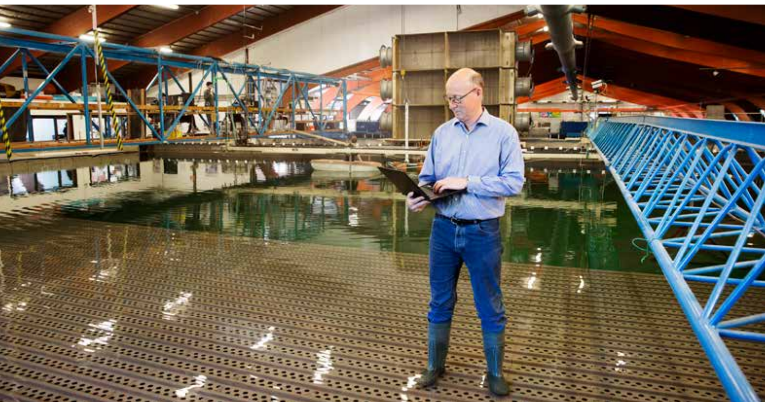
I DHI's vandbassin er det muligt at lave undersøgelser af både vind og bølger. Foto: Jon Norddahl
