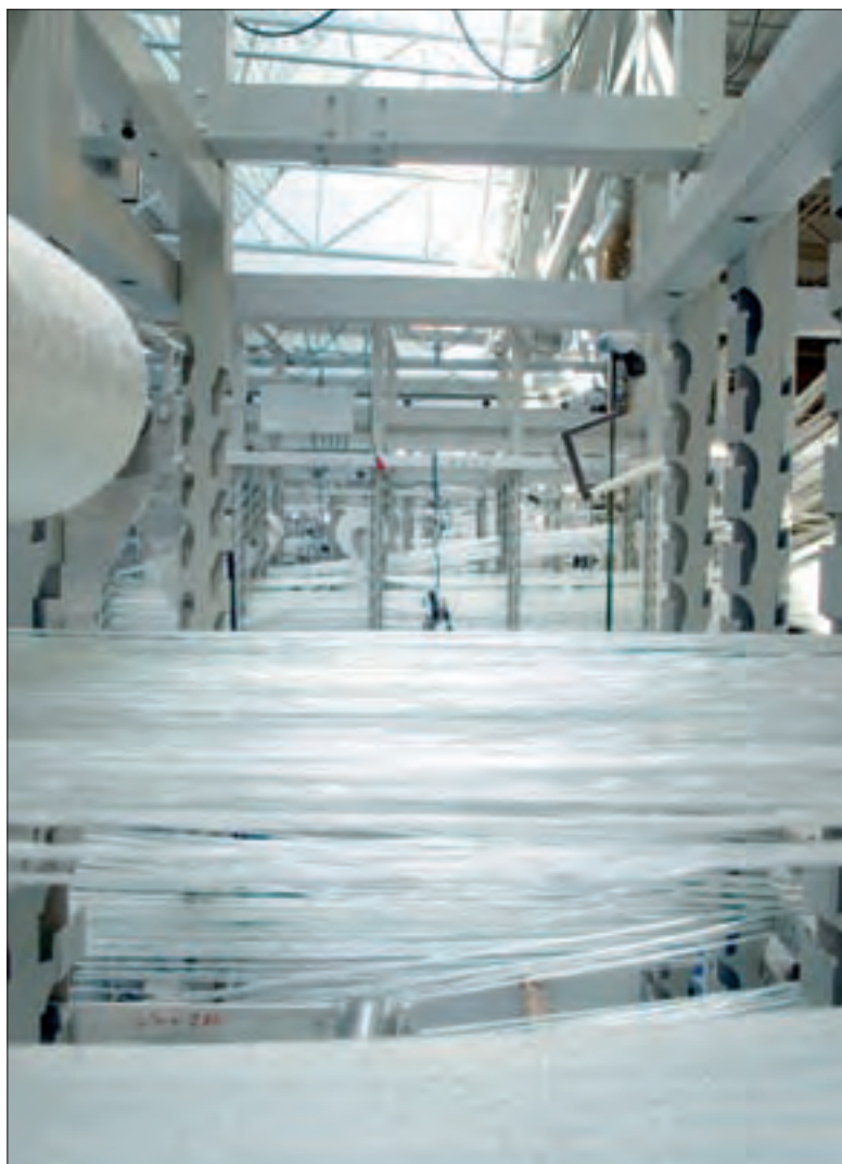
Virksomhedens produkter består af 60-70 procent glasfibre, der indstøbes i en plastmatrix.
